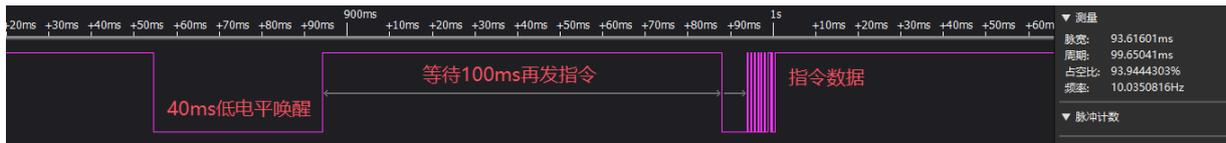
接收到 0xF0，系统会进入超低功耗，所以需要先发 40ms 低电平唤醒后至少要等待 100ms 再进行控制播放。进入超低功耗后想要控制进行播放音频，如果没有特殊要求尽量提前 200ms 唤醒，然后再发指令。播放情况是唤醒后退出超低功耗模式，然后播放音频 002。
